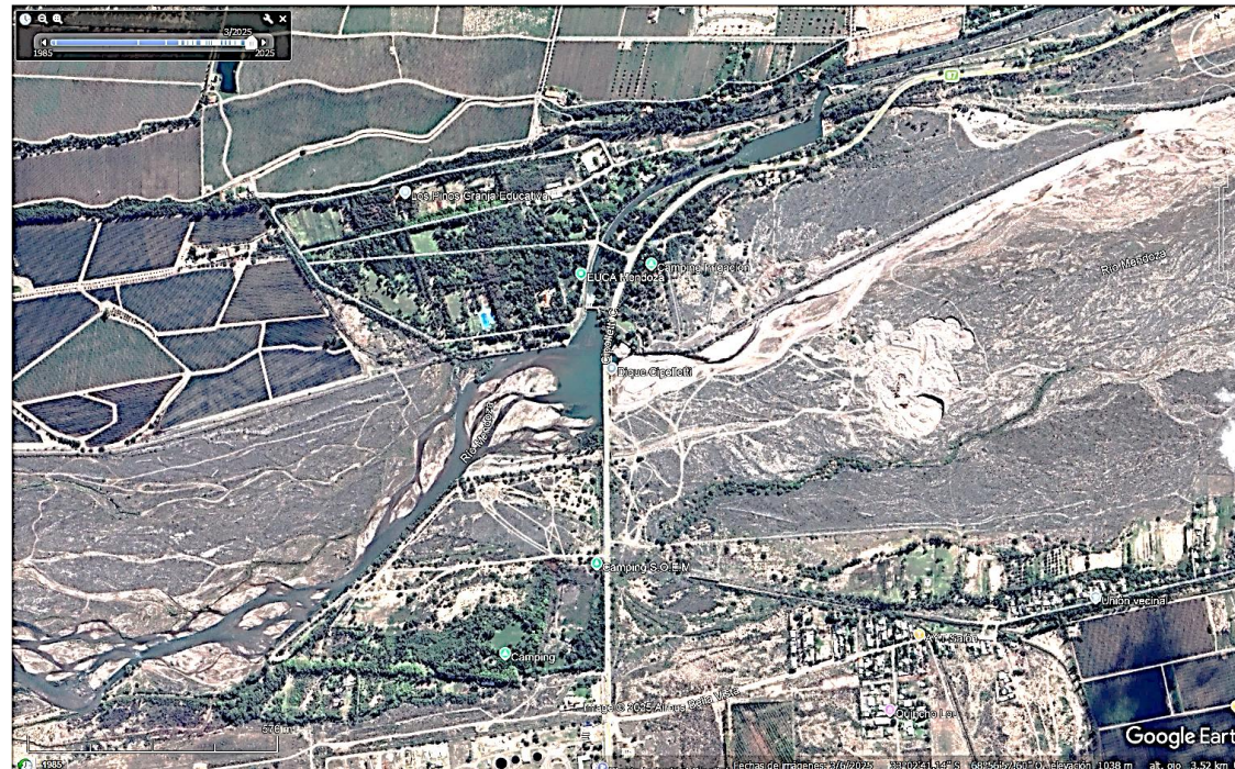
Fig. 8.3. Desvío del 100% de los caudales superficiales del Río Mendoza. Dique Cipolletti. Ubicado a sólo 10 kilómetros del frente de la precordillera, en cercanías a Luján de Cuyo, el dique captura el flujo de agua y la conduce a distintos sitios productivos y urbanos del oasis mendocino. Nótese hacia el este de la estructura, no hay agua en el río. Este dique que data de fines del siglo 19, es clave para el manejo no sustentable del río Mendoza. La imagen es de marzo de 2025. Las imágenes correspondientes a 1985 hasta la actualidad son exactamente iguales. Norte arriba.
