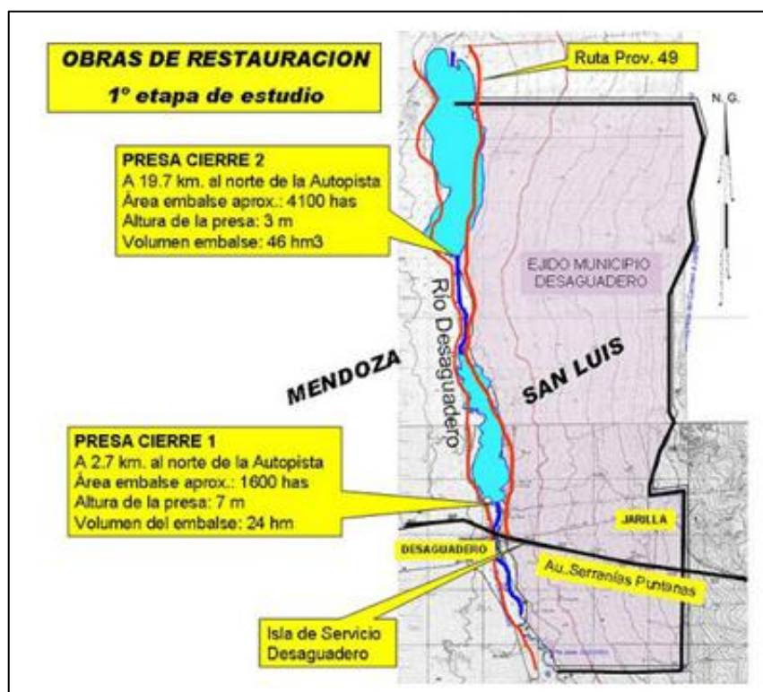
Figura 5.3. Los dos azudes construidos por la Provincia de San Luis, en cercanías a la localidad de El Desaguadero
