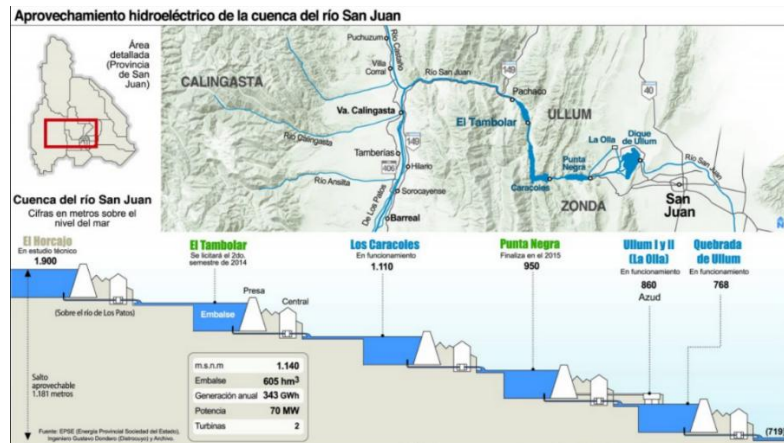
Figura 2.5 embalses sobre el río San Juan. Nótese la intensa infraestructura presente para la regulación de los recursos hídricos. Tomado de https://catedrageoargentina.blogspot.com/2015/09/san-juan-ya-construye-una-nueva-represa.html
